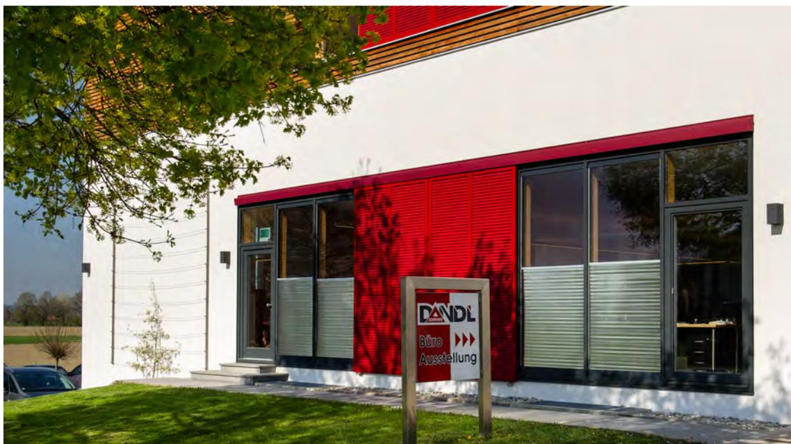
*Abb. 1 – ISO-Roll – Das Sonnenschutzrollo läuft in diesem Objekt von unten nach oben und schützt tagsüber vor neugierigen Blicken.*
