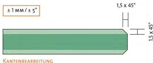
Die Diagonaltoleranz ergibt sich aus  $1,42 \times$  Rechtecktoleranz. (Bsp.: 2300 mm Kantenlänge daraus folgt  $1,42 \times 2,3 = 3,3$  mm  $\rightarrow$  3 mm Diagonaltoleranz)
